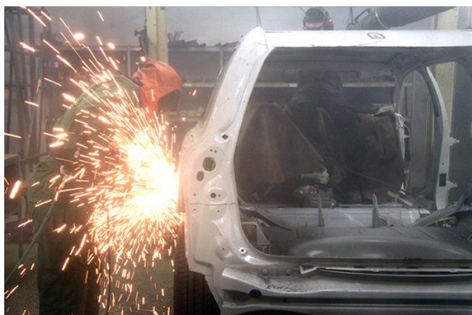
Demonteringen av vad som ska bli en ambulans påbörjas; Anders Enochsson hanterar vinkelslipen.
