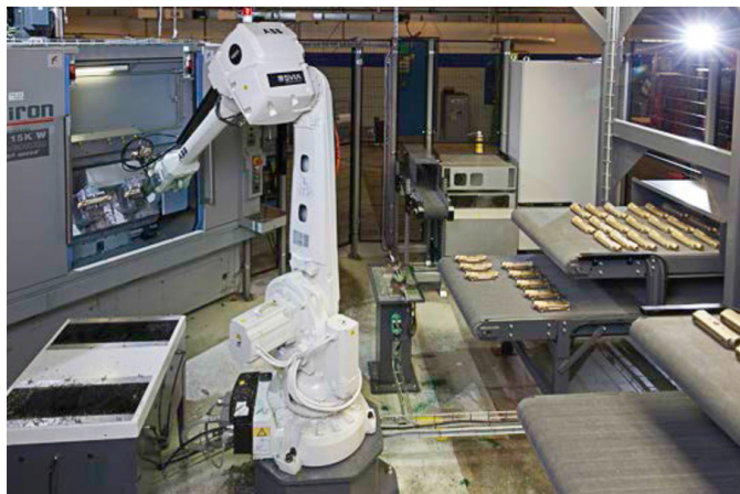
FM Mattsson Mora Group har satsat stort på automation de senaste åren. Detta är från en automatcell för skärande bearbetning av termostater.
