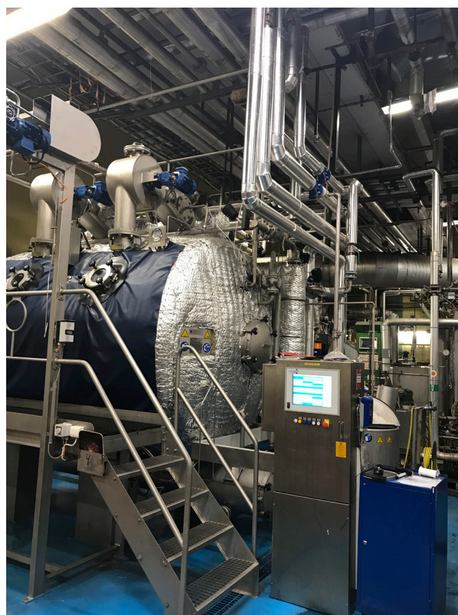
Företagets senaste investering, en jutfärgningsmaskin.
