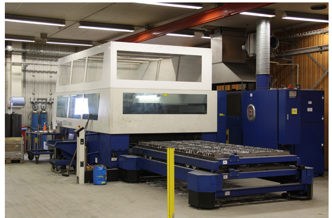
Laserskärmaskinen som till stor del utgör starten av produktflödet genom fabriken.
